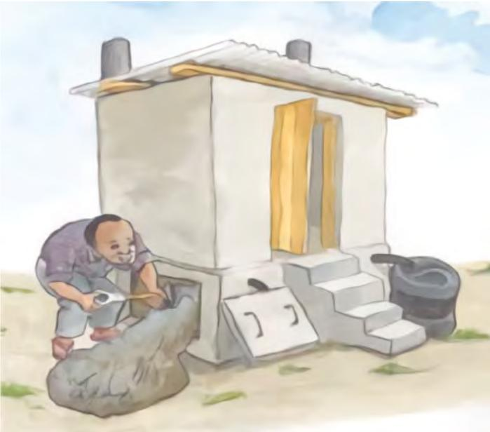
Le dispositif Ecosan, de type latrines sèches, fonctionne sans eau. Il sépare les fèces des urines et permet de valoriser les déchets en les transformant en compost (excréta) ou en fertilisant liquide (urines) utilisables pour la fertilisation des sols ou des cultures. Il s'agit donc d'une latrine à compost améliorée.
